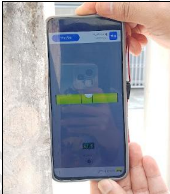
Gambar 3. Gapura Tegaltandan Barat diukur dengan waterpass menunjukkan kemiringan 3.6' (Sumber: TACB Bantul, 2025)
