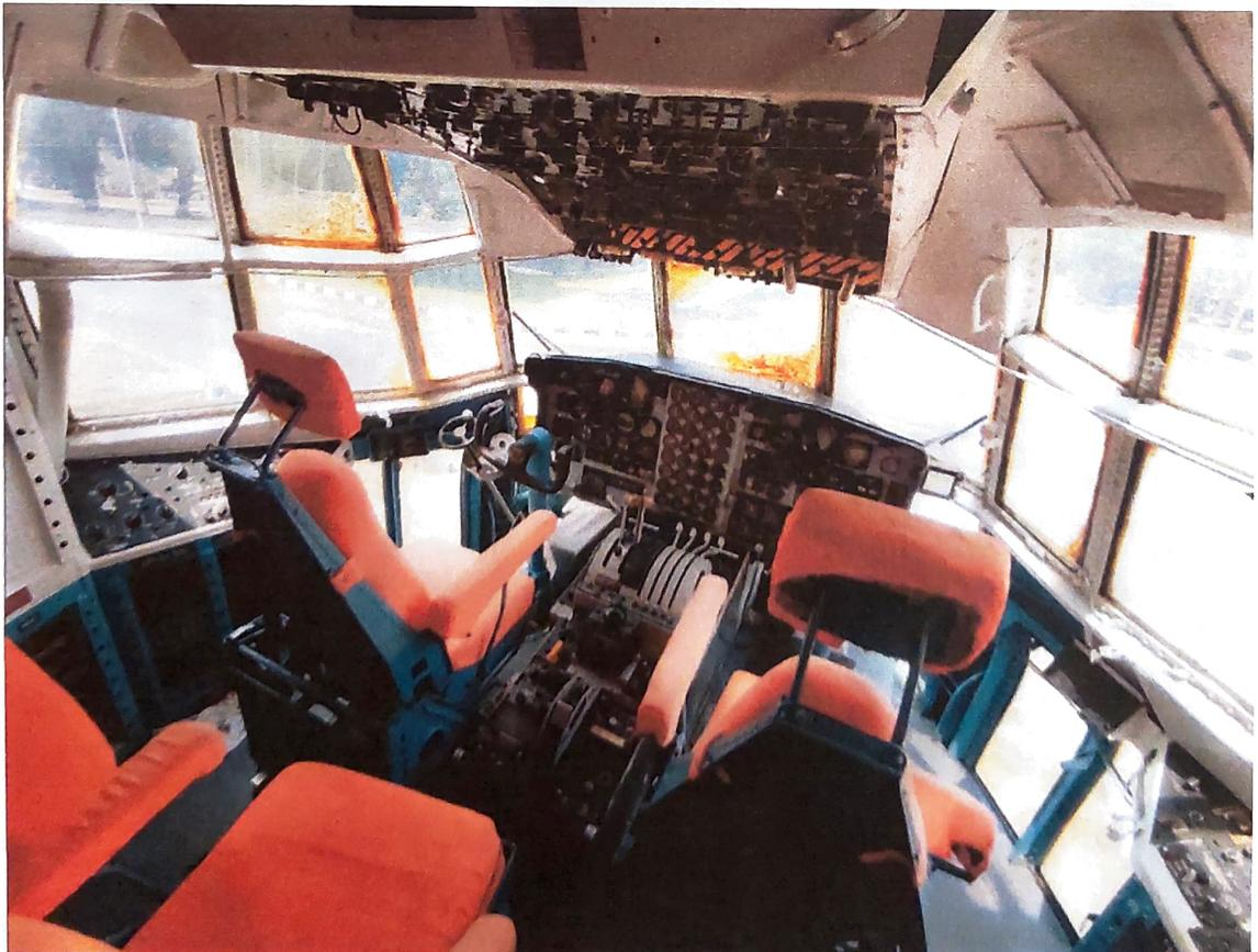
Gambar 5. Tampak bagian depan kokpit pesawat Hercules
