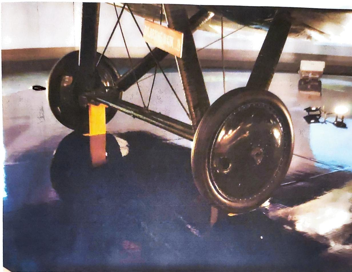
Gambar 2. Foto detail roda depan pesawat Cureng
