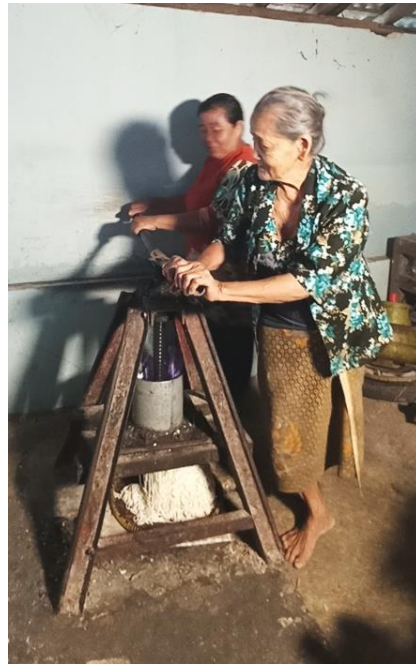
Foto 8: Mesin giling pencetak mi pentil yang memanfaatkan bekas rel lori Pabrik Gula Pundong
