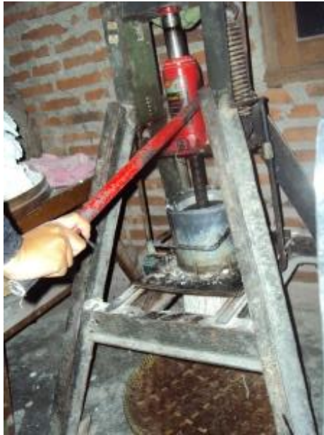
Foto 15: Mesin pres mi dengan modifikasi
