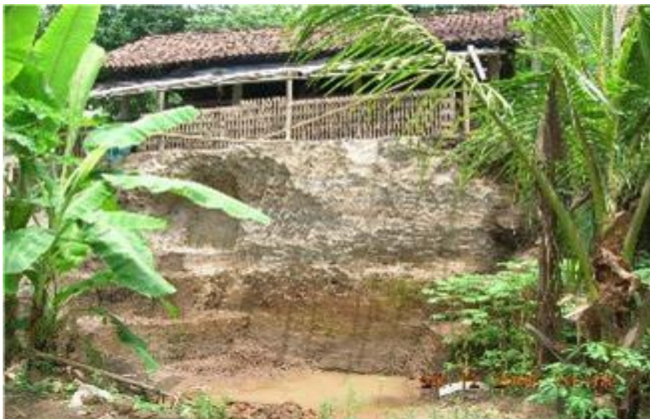
Profil stratigrafi tanah lokasi Lemah Duwur yang menunjukkan lapisan tanah urug untuk meninggikan permukaan tanah
