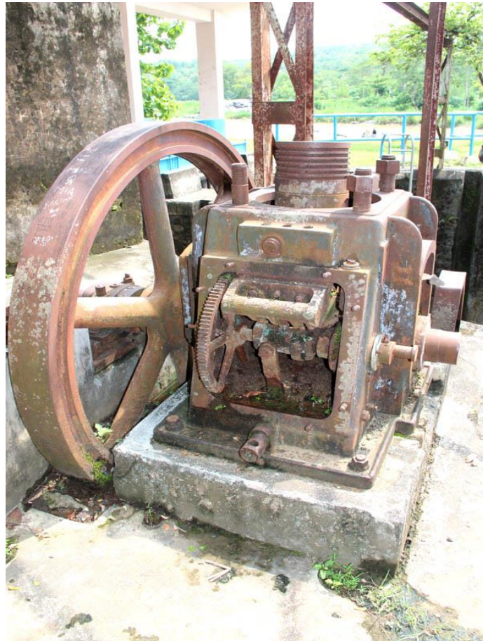
Sisa mesin merk Ruston yang dulunya digunakan untuk menyedot lumpur di Dam Kamijoro, difoto: 11 Februari 2014, (Foto: Albertus Sartono)
